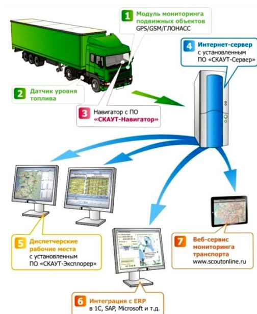
Рисунок 2 – Система контроля автотранспорта и учета топлива «СКАУТ»
