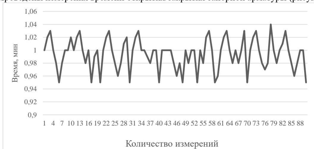
Рисунок 1 – Измерение времени открытия/закрытия запорной арматуры
