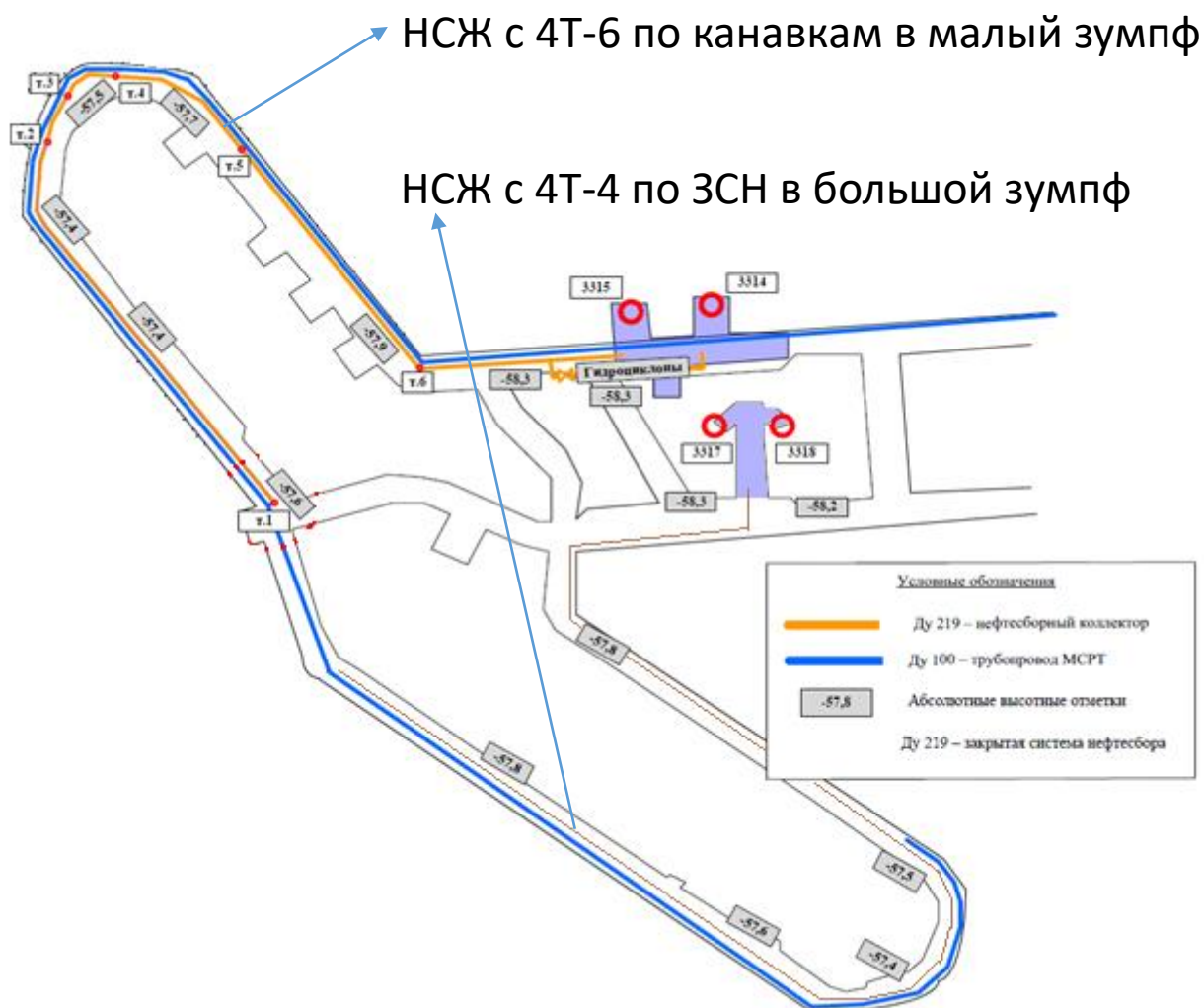
Рисунок 2 – Принципиальная схема УБ 4Т-4 НШ-1 НШПП «Яреганефть»
