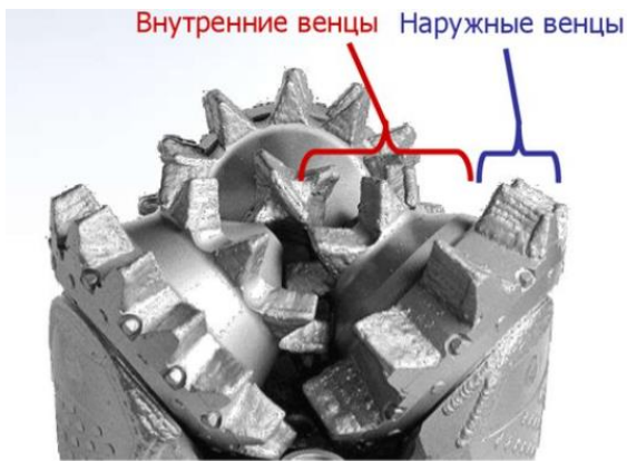
Рисунок 2.2– Внутренние и внешние венцы шарошек
