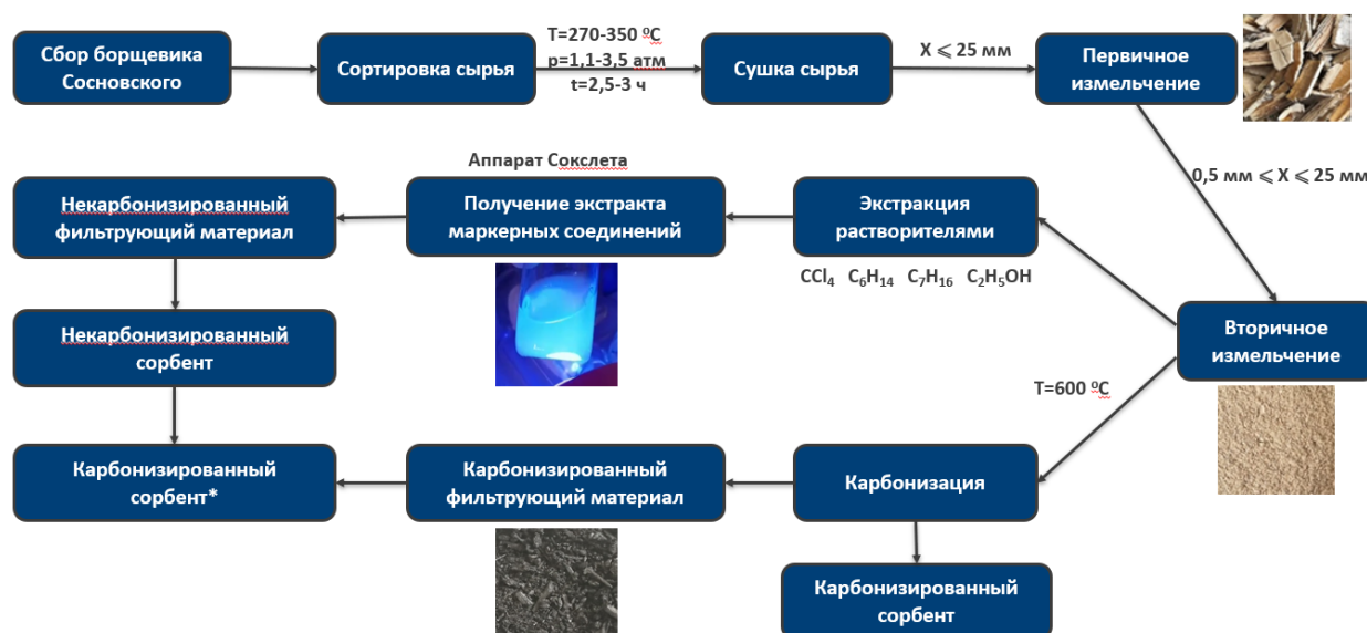
Рисунок 4 – Блок-схема получения маркерных, фильтрующих и сорбирующих материалов
