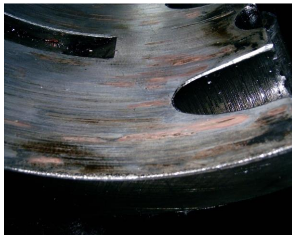
Рисунок 3 – Медное (серповитное) покрытие на поверхностях трения, образовавшаяся из смазочного материала
