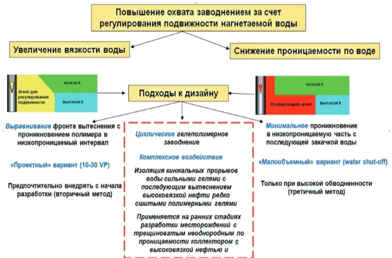
Рисунок 2 – Подход к дизайну циклического гель-полимерного заводнения
