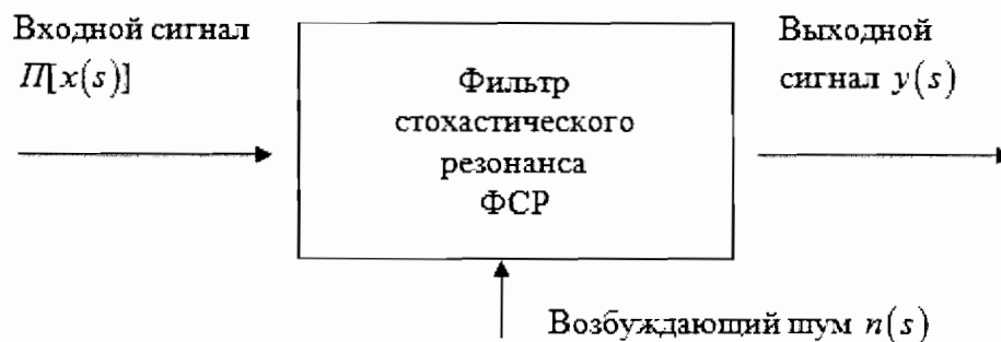
Рис. 1. Принципиальная схема фильтрации на основе стохастического резонанса
