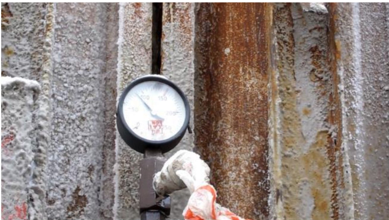
Рисунок 30. Узел подключения РПД ИМ2440М к манифольдной линии [20]
