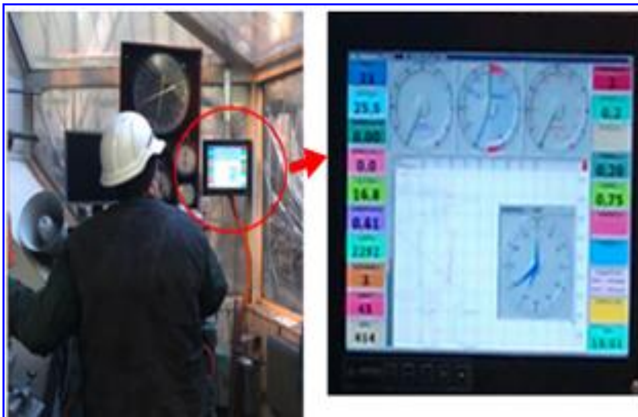
Рисунок 24. Рабочее место бурильщика IRI/IDECO 1700/270 процесса бурения. Работа ведется в режиме «самоконтроля» [18]
