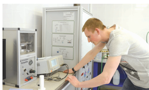
Этот прибор измеряет удельное электрическое сопротивление образцов.
