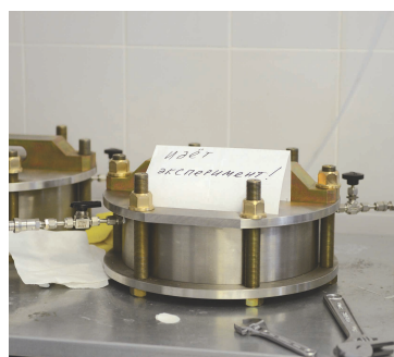
Капилляриметр позволяет получать сведения о структуре порового пространства.
