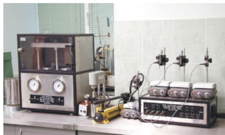
Лабораторное оборудование для определения свойств буровых и цементных растворов (камня) кафедры бурения.
