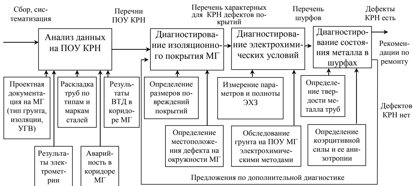
Рис. 10 - Схема выполнения мониторинга стресс-коррозионного состояния МГ
