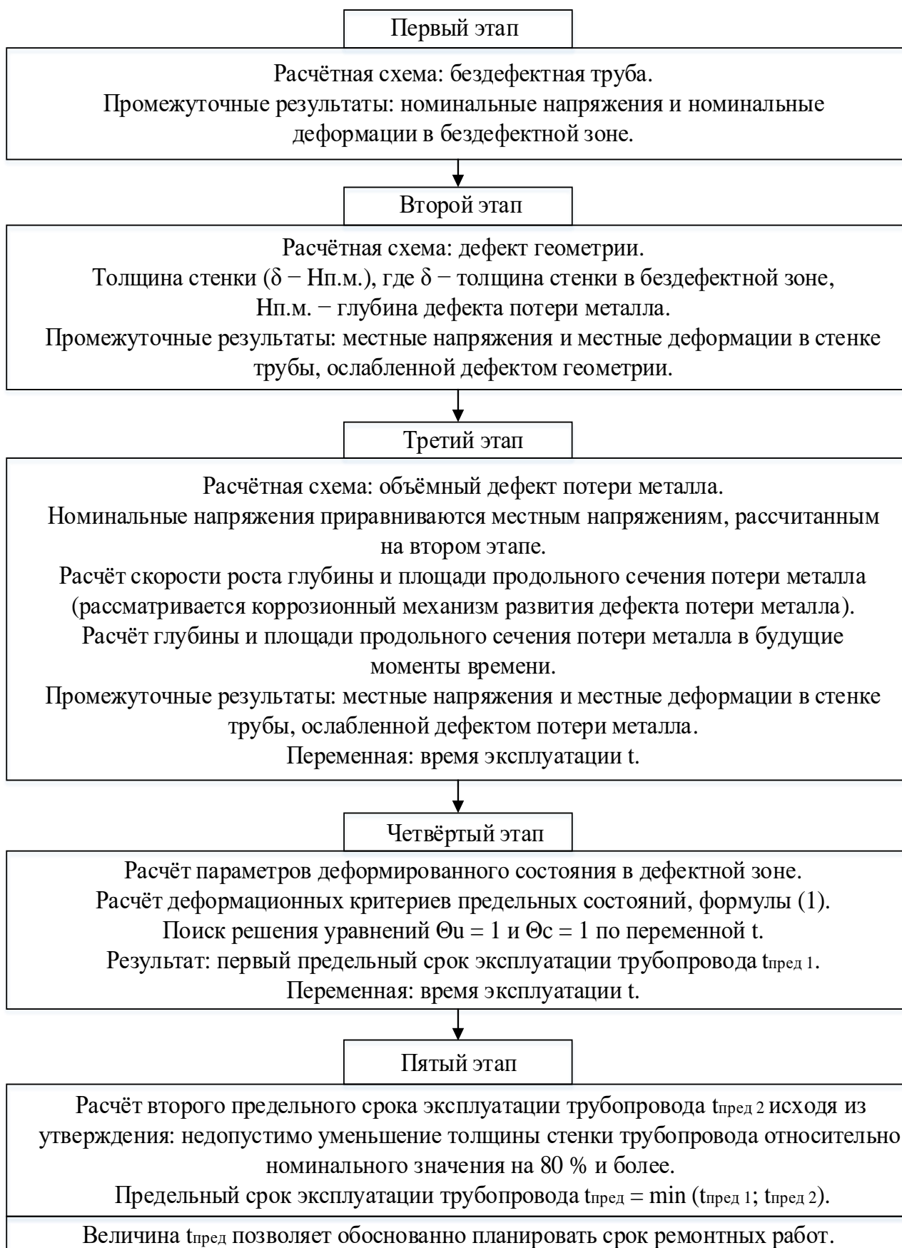
Рис. 4. Алгоритм расчёта на долговечность секции магистрального нефтепровода с комбинированным дефектом типа «дефект геометрии с потерей металла»
