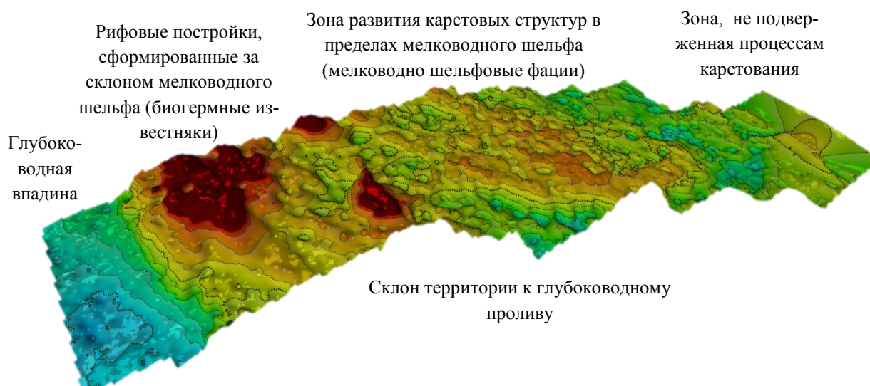
Рис. 5 – Палеорельеф изучаемого участка в доманиковское время (выполнен по результатам интерпретации сейсмических данных по ОГ Шf 2 )
