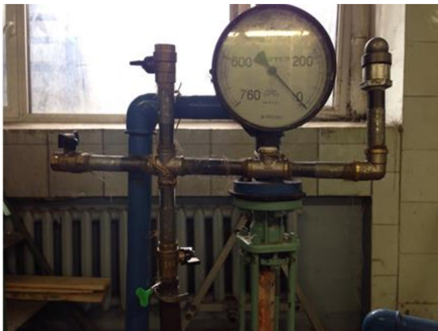
Рисунок 4.8 - Стенд для определения изменения давления вакуумирования под клапанным узлом
