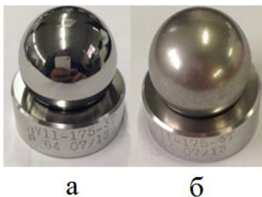
Рисунок 4.14 - Клапан VII-175-ST1. Всасывающий клапана. До (а) и после (б) испытаний
