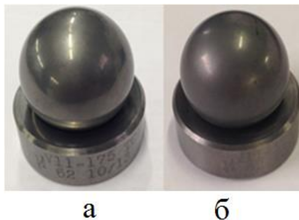
Рисунок 4.13 - Клапан VII-175-TC1. Всасывающий клапана. До (а) и после (б) испытаний
