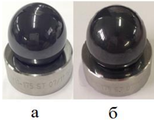
Рисунок 4.12 - Клапан VII-175-ST2. Всасывающий клапана. До (а) и после (б) испытаний
