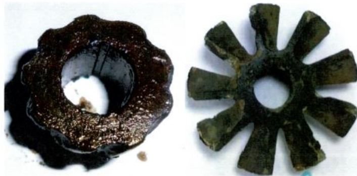
Рисунок 1 – Фотографии рабочих колес из алюминиевого сплава В-95-1 разрушенное и со следами абразивного износа
