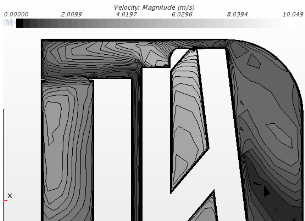
Рисунок 3.20 – Эпюра скоростей на выходе из рабочего колеса второй схемы габаритной группы 2А
