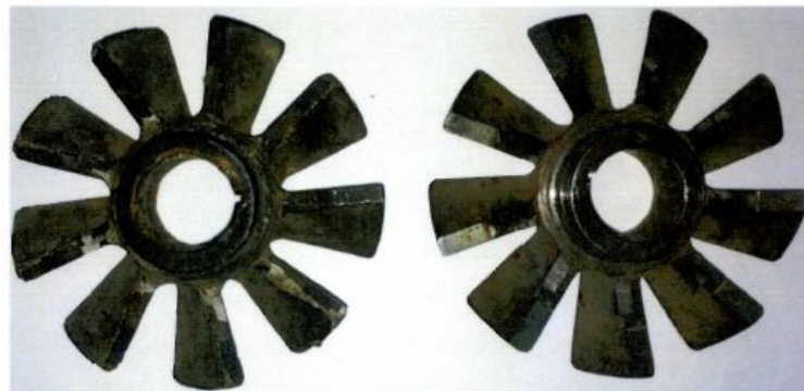
Рисунок 2 – Фотографии рабочих колес из алюминиевого сплава (слева) В-95-1 и из стали 40Х13 (справа)
