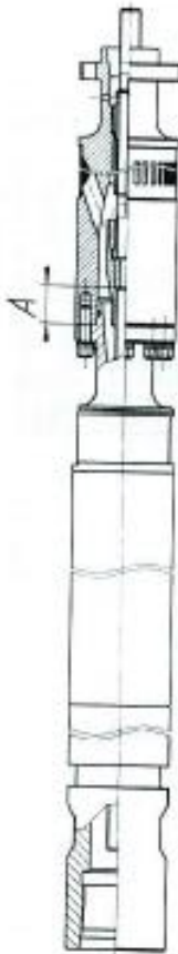
Рисунок Б.1 – Схема контроля вылета вала (размер А)
