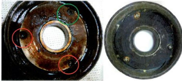
Рисунок 3 – Фотографии крепления диафрагмы направляющего аппарата, на фотографии слева отсутствуют головки винтов
