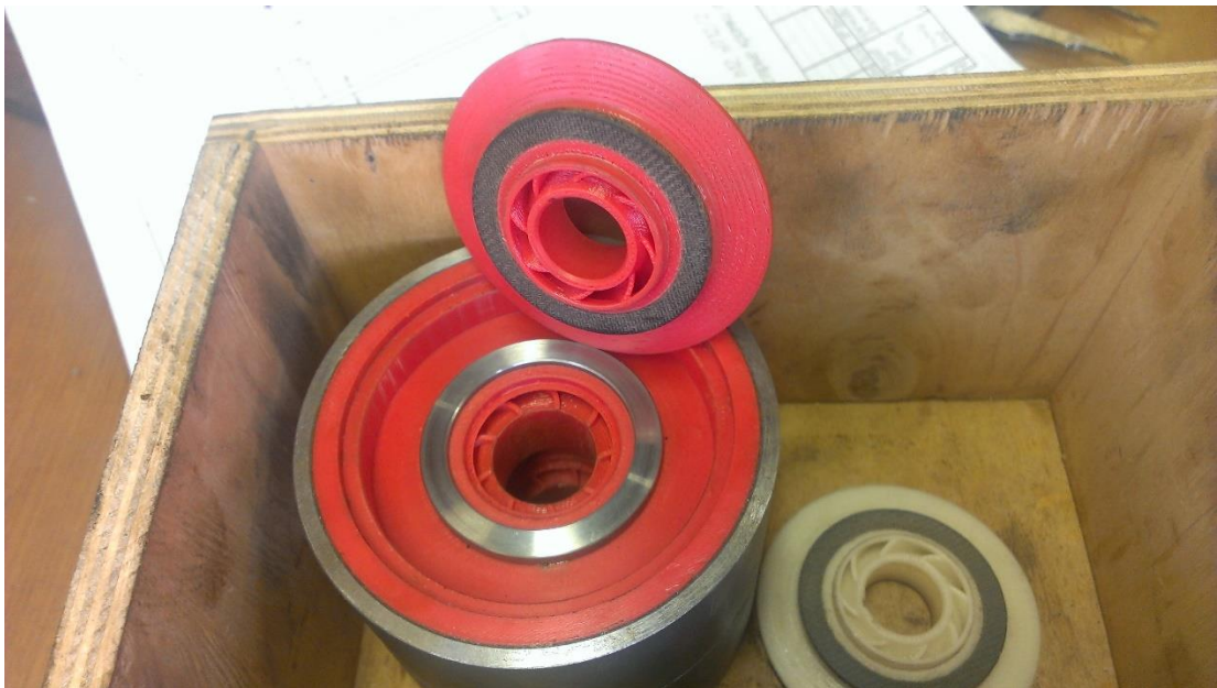
Рисунок 4.2 – Рабочая ступень, изготовленная на 3D принтере
