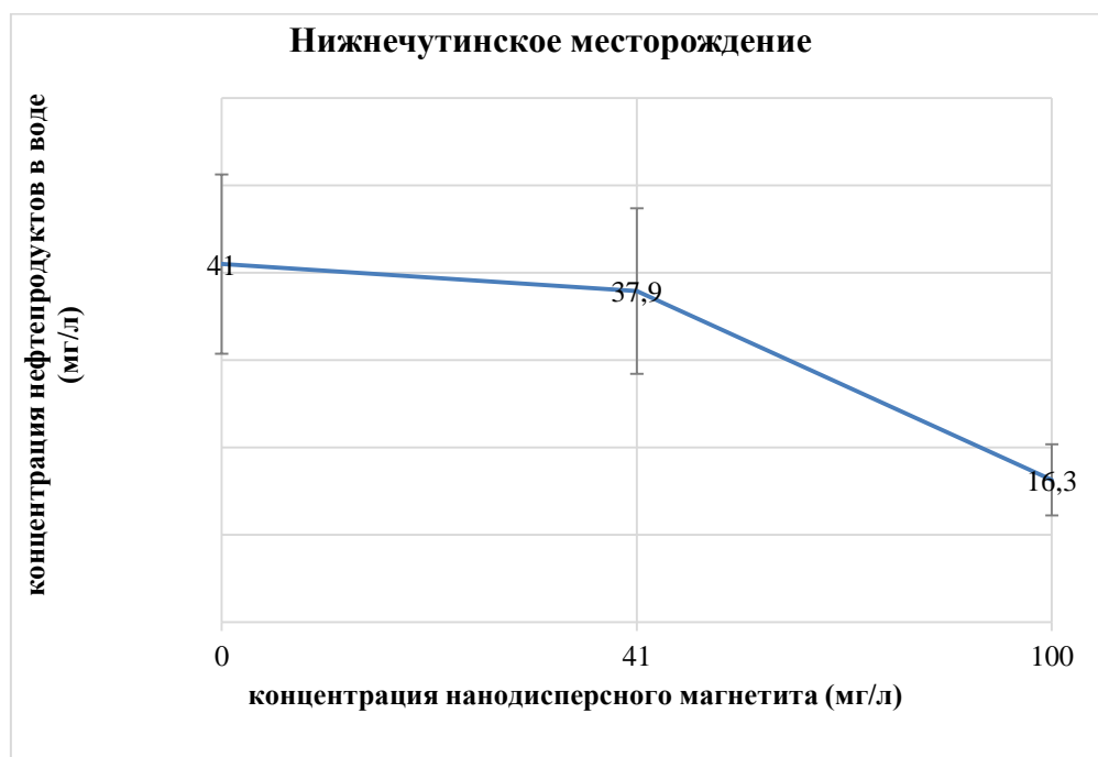
Рисунок 4.16 - Влияние массовой концентрации нанодисперсного магнетита на остаточное содержание нефтепродуктов
