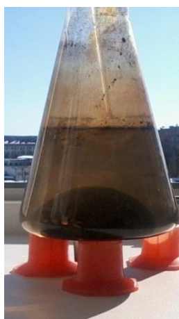
Рисунок 2.4 – Осажденный нанокодисперсный магнетит по реакции Massart
