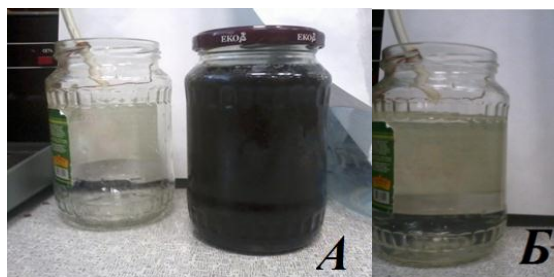
Рисунок 4.11 – Пропускание через магнитный сепаратор: А – до обработки, Б – после обработки
