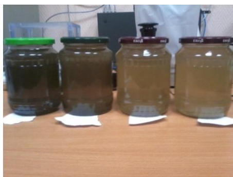
Рисунок 4.10 – Суспензия пластовой воды с дозированной концентрацией нанодисперсного магнетита
