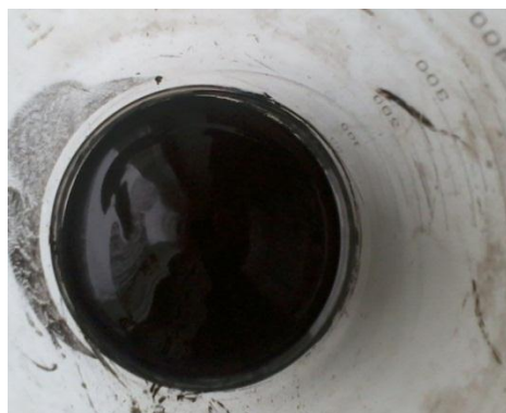
Рисунок 4.5 – Осажденный высокодисперсный магнетит по реакции Massart
