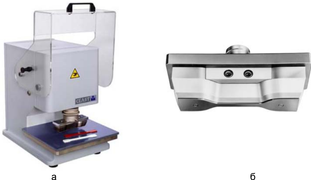
Рисунок 2.3 – Вырубной пневматический пресс (а) и вырубная матрица с выталкивателем (б)
