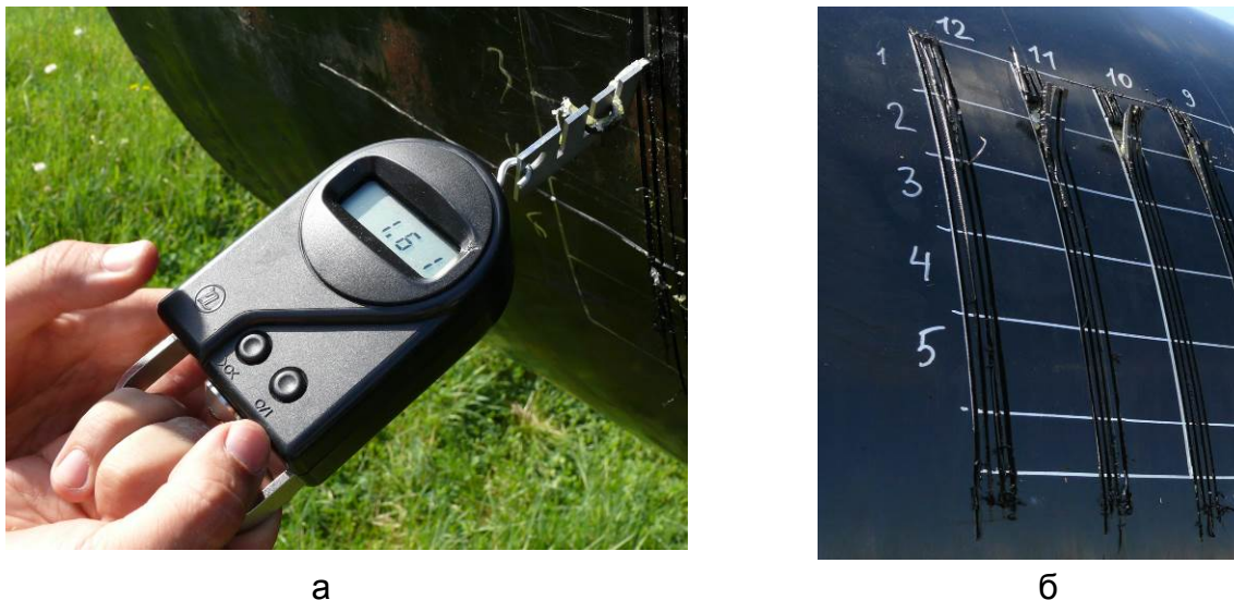
Рисунок 2.13 – Электронный адгезиметр АМЦ2-20 с универсальным захватом (а) и подготовленные к отслаиванию полосы защитного покрытия (б)
