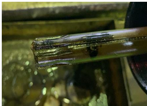
Рисунок 1.13 – Слом вала секции УЭЦН
