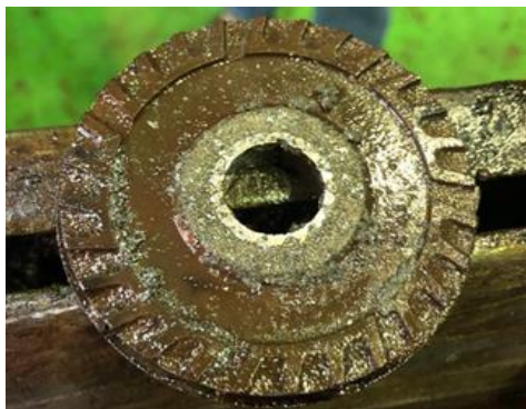
Рисунок 1.10 – Отложение солей и механических примесей на рабочем колесе УЭЦН
