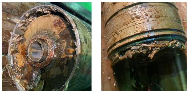
Рисунок 1.11 – Отложения солей и засорение ими проходных каналов
