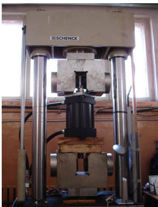
Рисунок 2.20 - Разрывная машина SCHENCK Гидропульс 1000 кН
