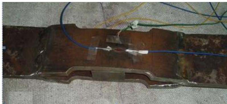
Рисунок 2.19 – Образец с установленными датчиками деформаций
