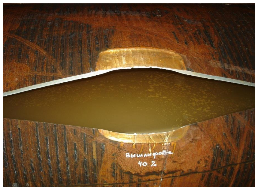
Рисунок 6.21 - Очаг разрушения трубной плети
