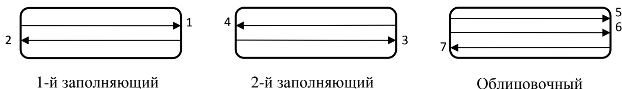
Рисунок 6.11 - Последовательность и направление заполняющих слоев при наплавке вышлифованных зон
