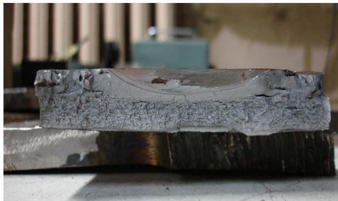
Рисунок 6.14 – Изломы образцов 2 - 4 группы после циклического нагружения а – образец 2-ой группы; б – образец 3-ей группы; в – образец 4-ой группы
