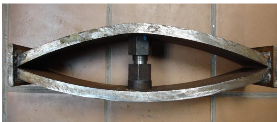
Рисунок 2.27 - Конструкция образца, испытываемого на статическое нагружение
