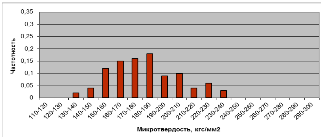
Рисунок 4.15 - Гистограммы распределения микротвердости трубы стали 17Г1С, полученные в различном пространственном положении
