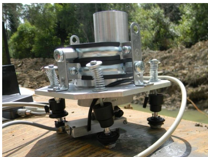
Рисунок 4.6. Оснастка для крепления микротвердомера «MicroLab-Z 1 » на трубу
