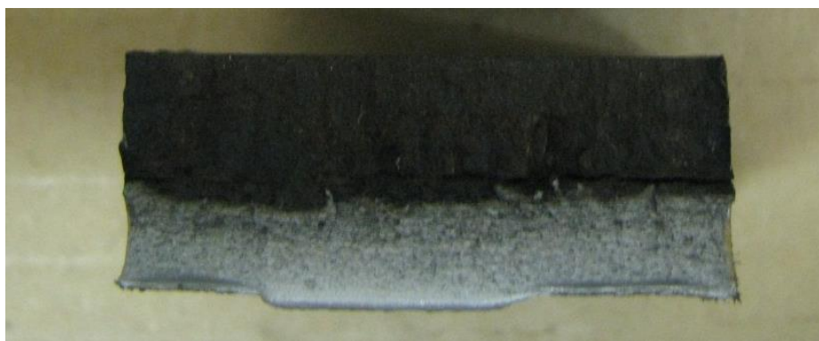
Рисунок 2.34 - Излом трещины из области №2
