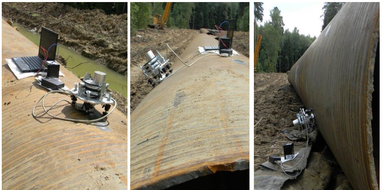
Рисунок 4.14 – Измерение микротвердости на трубе в различных пространственных положениях
