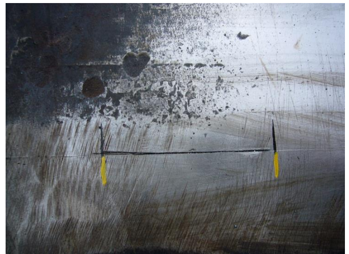
Рисунок 2.40 - Трещиноподобные концентраторы напряжений на трубной плети а – схема расположения концентраторов; б, в – фото нанесенных концентраторов
