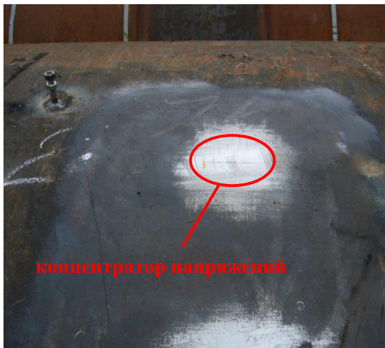
Рисунок 2.40 - Трещиноподобные концентраторы напряжений на трубной плети а – схема расположения концентраторов; б, в – фото нанесенных концентраторов
