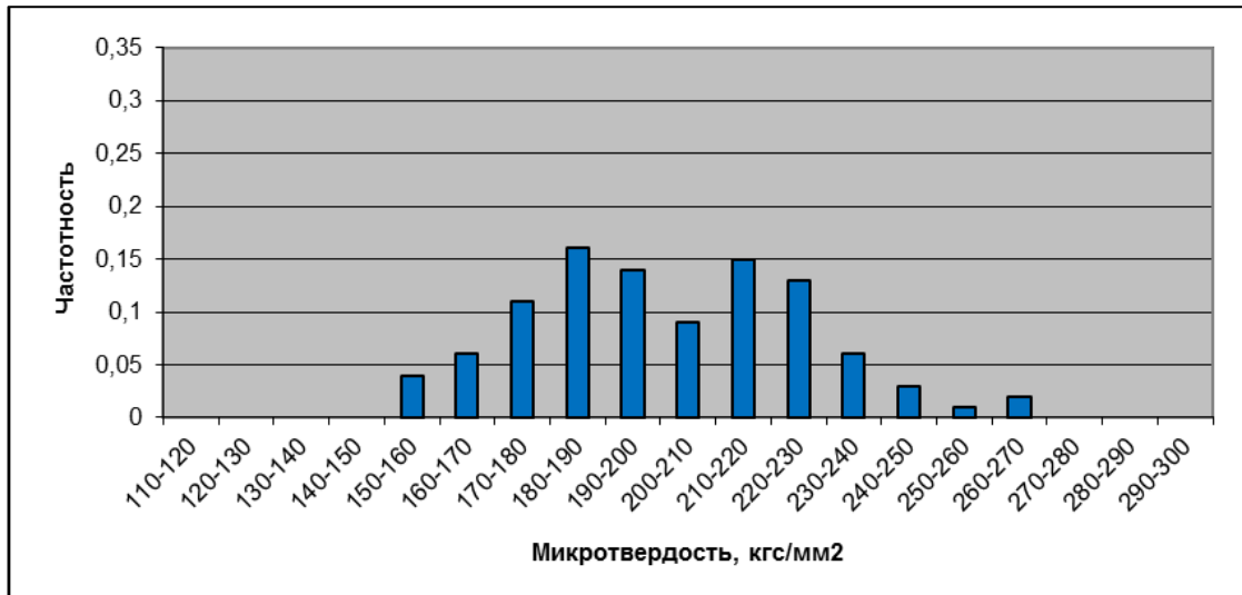
Рисунок 6.5 - Гистограмма распределения значений микротвердости стали X70 в исходном состоянии
