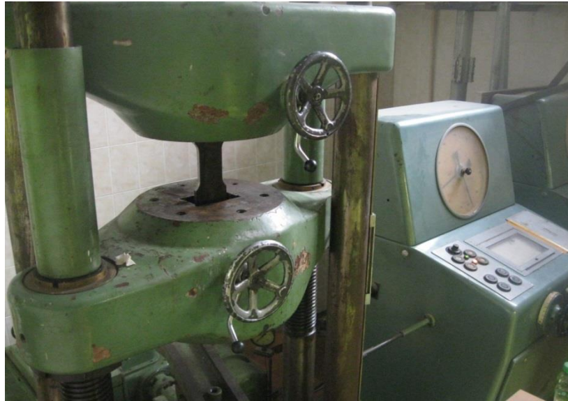
Рисунок 3.9 - Внешний вид машины ЦД-100-ПУ с установленным испытательным образцом
