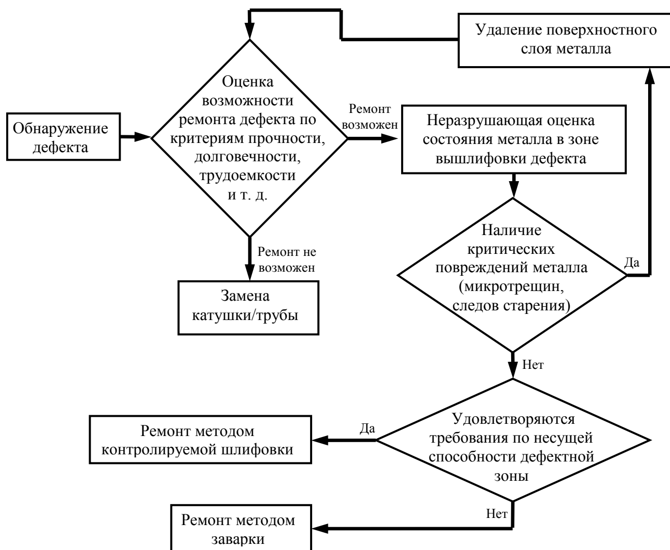
Рисунок 6.22 – Алгоритм выбора оптимальных методов ремонта труб
